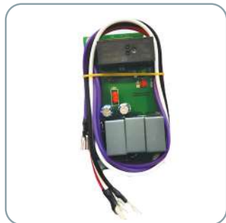
РЕЛЕ КОНТРОЛЯ ФАЗ
