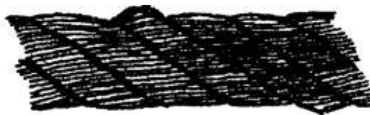
Рисунок 1. Обрывы и смещения проволок каната крестовой свивки.
