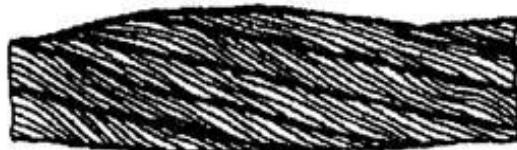
Рисунок 12. Выдавливание проволок прядей: а - в одной пряди; б - в нескольких прядях.
